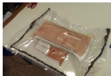
BLA fizelāžas detaļas vakuuma formēšanas process
