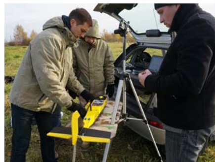
Autopilota komponentu pārbaude un uzstāšanās procedūra uz BLA testa prototipa
