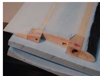
Centroplāna spārna pastiprināšo detaļu iestiprināšana
